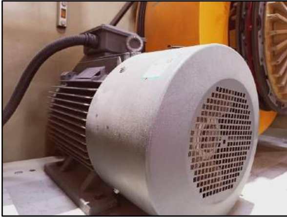
Şekil 64 200 ton eksantrik pres motoru 18,5 Kw
