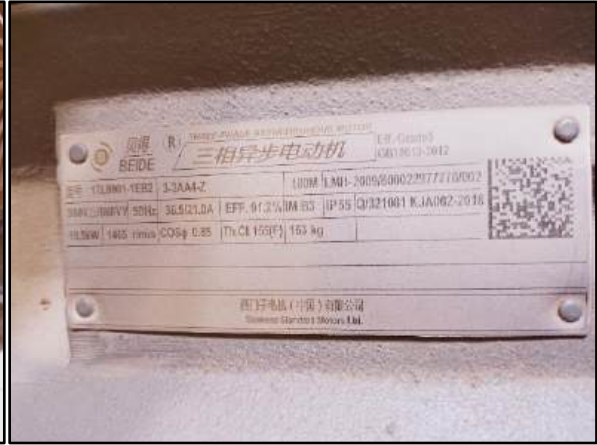
Şekil 64 200 ton eksantrik pres motoru 18,5 Kw
